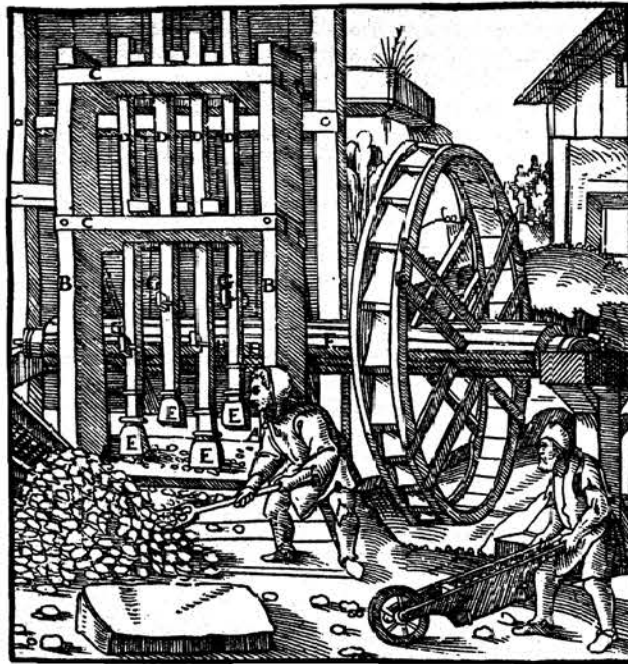
Il frantoio a pestelli azionato da ruota idraulica non è una novità del XVIII secolo: compare infatti già nel 1556 nei De re metallica libri di Giorgio Agricola.
